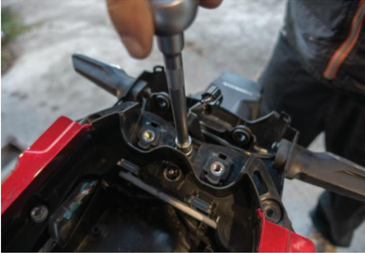
8. Retire los dos pernos de debajo del guardabarros trasero con un zócalo de 12 mm y una llave inglesa.
