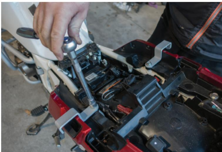
10. Retire la estribera del lado derecho del pasajero. Añada el espaciador provisto entre la pestaña frontal y el bastidor.
