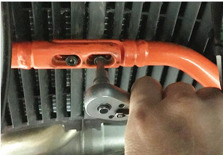
2. Retire los amortiguadores de dirección de fábrica usando un zócalo de 10 mm o un Torx T40. Consejo: comience con el perno que sujeta la articulación esférica.
