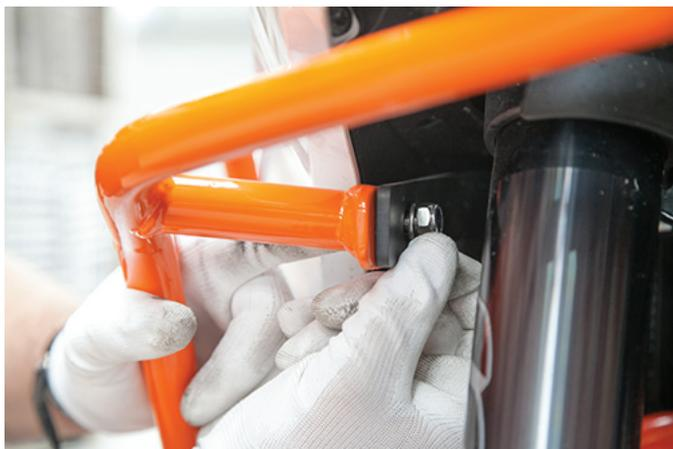
10. A continuación: tome una de las abrazaderas en forma de "C" y dos de los pernos M6x30mm + arandelas y tuerca de nyloc y asegure la parte inferior delantera de las barras de protección superior en las barras de protección inferior de fábrica.
