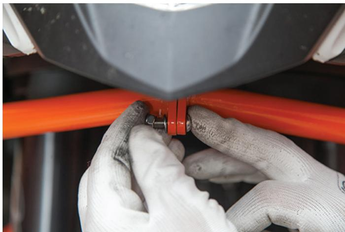
**16. Finalmente, apriete todos los pernos y tuercas según las especificaciones del par de torsión y asegúrese de revisarlo todo nuevamente después de salir a realizar una prueba de conducción.**
