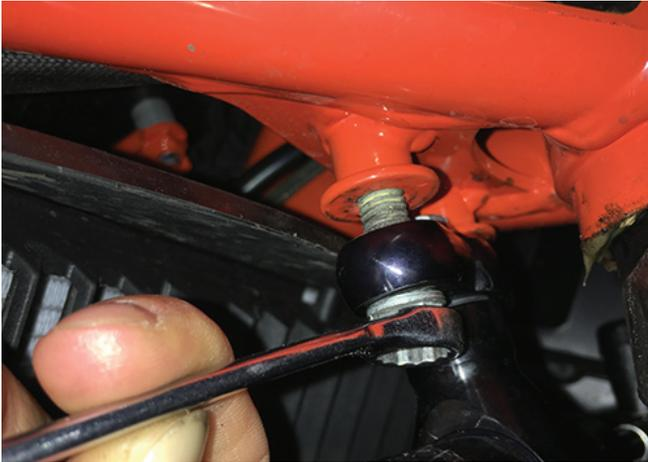
4. Monte el soporte suministrado. Alinee los orificios de montaje inferiores con los orificios de las barras de protección de fábrica e inserte los pernos M6x30mm suministrados. Consejo: Use cinta adhesiva para evitar que la parte superior del soporte se gire mientras trabaja para asegurar la parte inferior.
